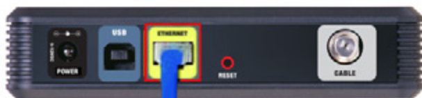
Vue arrière du modem câblé
